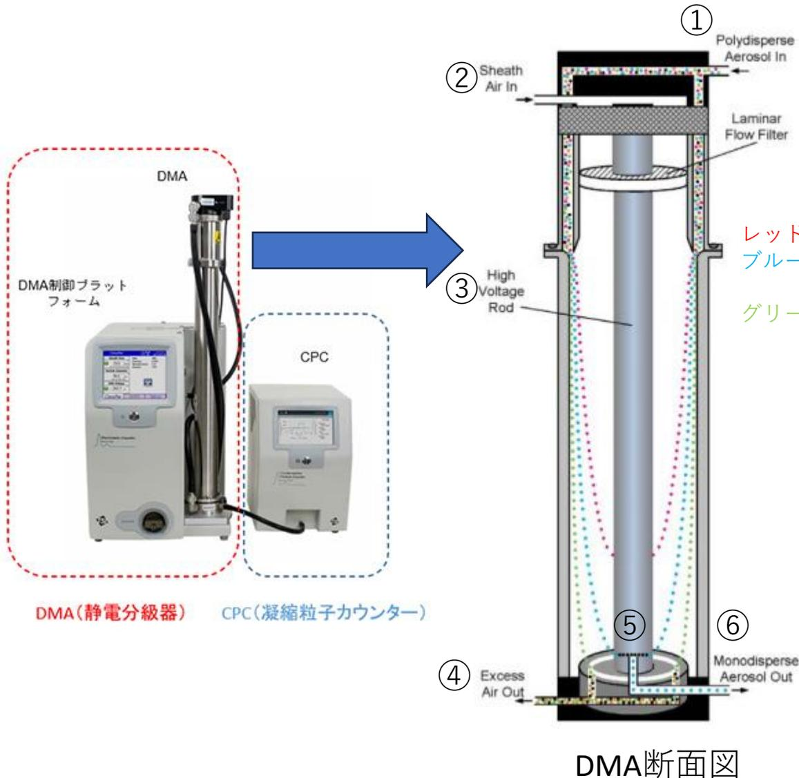
静電分級器 (DMA)は多分散エアロゾルの中から単分散エアロゾルを高精度で分級抽出可能な装置である。
